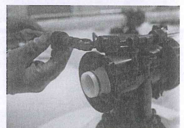
Etape 4- Serrer le tube de soutirage (15) sur le coude de soutirage (25) à l'aide de l'écrou en plastique.
