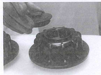
Etape 22- Dévissez le bouchon BCS 2" Gaz de l'entretoise fileté de la 4ème bonde.
