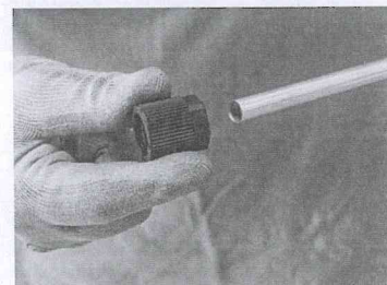
Etape 17- Prendre le tube alu de soutirage 16 et emboîter les écrous plastiques 15 .
