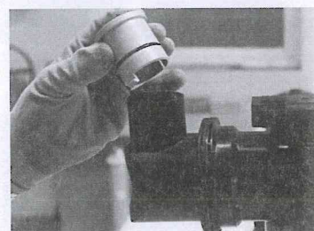
Etape 16- Emboîter le bouchon aération 11 dans le coude d'aération Ø70 8 .
