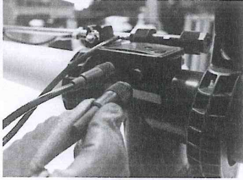
Etape 23- Le connecteur (4) doit toujours être en place sur le dernier Ensemble EC (14).
